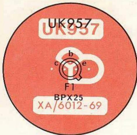
Fig. 2/a - Montaggio del fototransistore.
